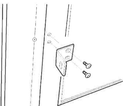
右ガラス枠裏側に①L型金具を②L型金具用ビスにて取付けてください。
