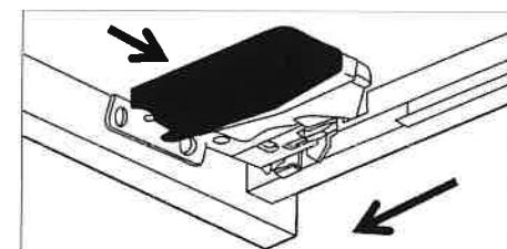
引出しを戻すときは、レールを引き出して、引き出しの後板の溝に合うように乗せ、そのまま水平に閉めてください。
