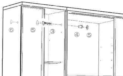
上台同士をジョイントする際は、片側に④ジョイントナットをジョイント穴に挿入し、もう片側から③40mmボルトをプラス(+)ドライバーにて固定してください。
